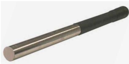
Einzelquerkraftdorn zur Querkraftübertragung im Bereich von Dehnfugen. Dorn halbseitig plastifiziert mit Federelement. R 90-Ausführung mittels Brandschutzmanschette.
