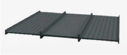
KUNEX® Arbeitsfugenband innenliegend aus PVC-P zur Abdichtung von Arbeitsfugen in Betonbauwerken. Einbau mittig im Betonquerschnitt.
