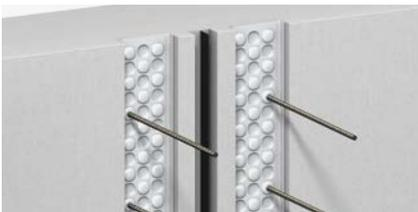
PENTAFLEX® Modul zur Abdichtung von Arbeitsfugen mit durchlaufender Schalung, z. B. zwischen Wand und Tiefgaragenrampe oder zwischen Lichtschacht und Kellerwand. Das Element besteht aus einer Verwarbox und integriertem 60 mm breiten Fugenblech PENTAFLEX KB®. Der Aufbau des Moduls garantiert, dass das Fugenblech gemäß **abP** jeweils 30 mm in die anzuschließenden Bauteile einbindet.
