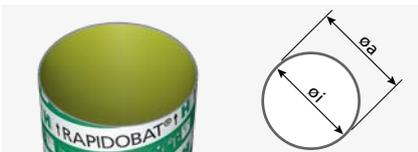
Schalrohre für höchste Ansprüche an die Sichtbetonoberfläche. Die aktivierbare Hydrogel-Schalhaut von RAPIDOBAT® Cretcon HD minimiert die Lunkerbildung und sorgt für ein gleichmäßiges Farbbild der fertigen Betonstütze. Damit ist eine sichere Einordnung in die Sichtbetonklasse SB4 möglich.
