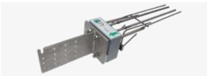
Wärmedämmter Anschluss zur Übertragung von Biegemoment und Querkraft sowie Horizontalkräften beim Anschluss einer auskragenden Holzkonstruktion an ein Stahlbetonbauteil.
