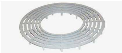
Großflächiger Abstandhalter aus Kunststoff mit punktueller Auflage für horizontale Matten- und Rundstahlbewehrung. Bestehend aus leicht trennbaren 6er-Ringen.
