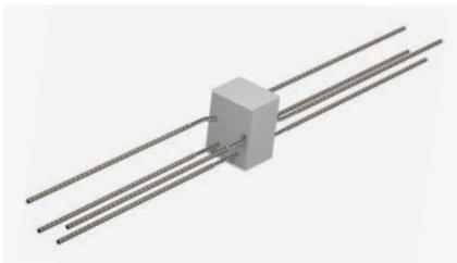
Wärmedämmter Plattenanschluss zur Übertragung von horizontalen Kräften parallel und/oder senkrecht zur Dämmebene. Punktueller Einsatz als Ergänzung der Linienanschlüsse z. B. Typ IP 120 M, IP 120 Q. Korrosionsschutz durch nichtrostenden Betonrippenstahl.
