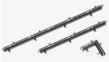
PENTAFLEX® Modul zur Abdichtung von Arbeitsfugen mit durchlaufender Schalung, z.B. zwischen Wand und Tiefgaragenrampe oder zwischen Lichtschacht und Kellerwand. Das Element besteht aus einer Verwehrbox und integriertem 60 mm breitem Fugenblech PENTAFLEX KB®. Der Aufbau des Moduls garantiert, dass das Fugenblech gemäß **abP** jeweils 30 mm in die anzuschließenden Bauteile einbindet.
