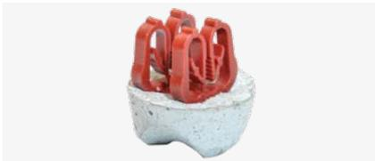
Einzelabstandhalter mit geringer Aufstandsfläche aus Gießbeton mit Kunststoffklammer zur Befestigung an der Bewehrung. Keine Metall- und Drahtteile in der Betondeckung.
