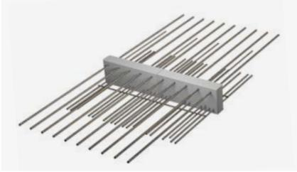
Wärmedämmter Kragplattenanschluss für frei ausragende Stahlbetonbauteile. Korrosionsschutz durch nichtrostenden Betonrippenstahl, mit balkenseitig integrierter Aufhängebewehrung. Brandschutzausführung lieferbar.
