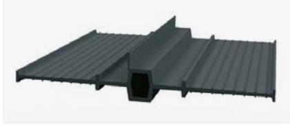
KUNEX® Dehnfugenband innenliegend aus PVC-P zur Abdichtung von Dehnfugen in Betonbauwerken. Das Fugenband nimmt Dehn- und Scherbewegungen auf. Einbau mittig im Betonquerschnitt.
