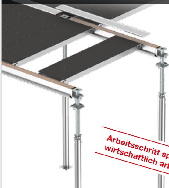
Das **Combi Paneel** besteht aus einem leichten Aluminiumrahmen mit integrierter Schalhaut. Es wird zwischen den Hauptträgern eingehängt und ermöglicht vorschriftsmäßiges Ein- und Ausschalen von unten. Das Combi Paneel kann mit allen Systemkomponenten kombiniert werden. Beischalen erfolgt mit 21 mm Schalhaut.
