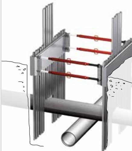
**Systemlösung zum Sichern gegen Einbruch nach DIN 4124**
