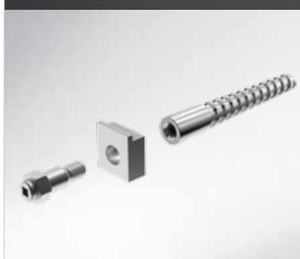
Fixierung des Auflagers der Wandkonsole über den einbetonierten wiedergewinnbaren **Schraubanker TITAN** aus vergütetem Stahl. Der Einbau kann über eine Kernlochbohrung auch nach dem Betonieren erfolgen.
