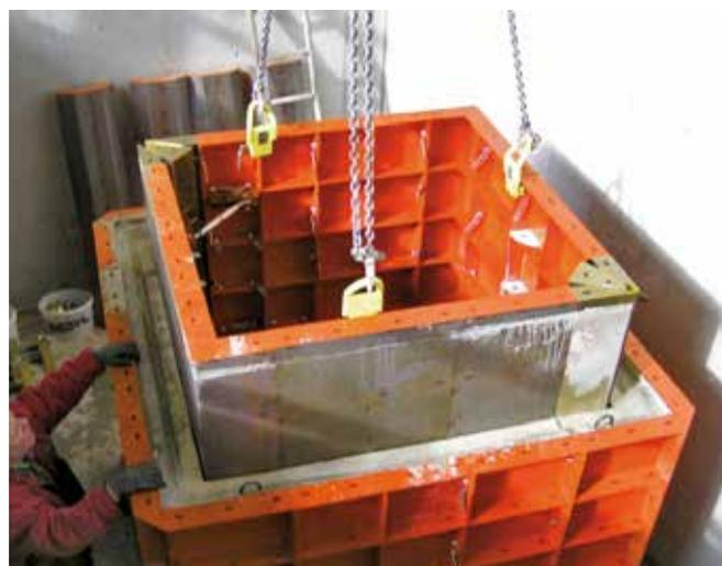
Spannstellenlose Stahl-Schalung für Schächte und Lichtschächte mit Kopf- und Fußform zum Aufstücken.
