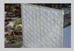
In Verbindung mit einer zusätzlich aufgeschrumpften speziellen Luftpolsterfolie erreicht man Wärmedämmwerte ähnlich wie bei normalem Isolierglas. Dieses Material ist speziell für den beheizten Winterbau entwickelt worden.
