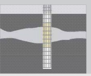
Bei manchen Bodenverhältnissen ist es erforderlich, Bohrpfähle mit einer Schalung zu versehen. Die Schalung sollte so beschaffen sein, dass sie sich auf dem Bewehrungskorb befestigen lässt und mit ihm in das Bohrloch eingeführt wird. Sie muss jedoch so flexibel sein, dass sie sich beim Betonieren des Bohrpfahls an das umgebende Erdreich fest anlegt.
