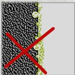
Das nahezu vollständige Fehlen von Lunkern mindert die Lebensbedingungen für Mikroorganismen. Trinkwasserbehälter aus naturbelassenem Beton ohne Verwendung von Betontrennmitteln sind Gewähr für hygienisch einwandfreies Trinkwasser.
