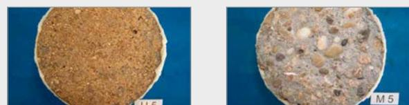
Bild 2: Unterschied zwischen den Betonkernen (links mit, rechts ohne Zemdrain®) nach 56 Frost-/Tauwechselln.
